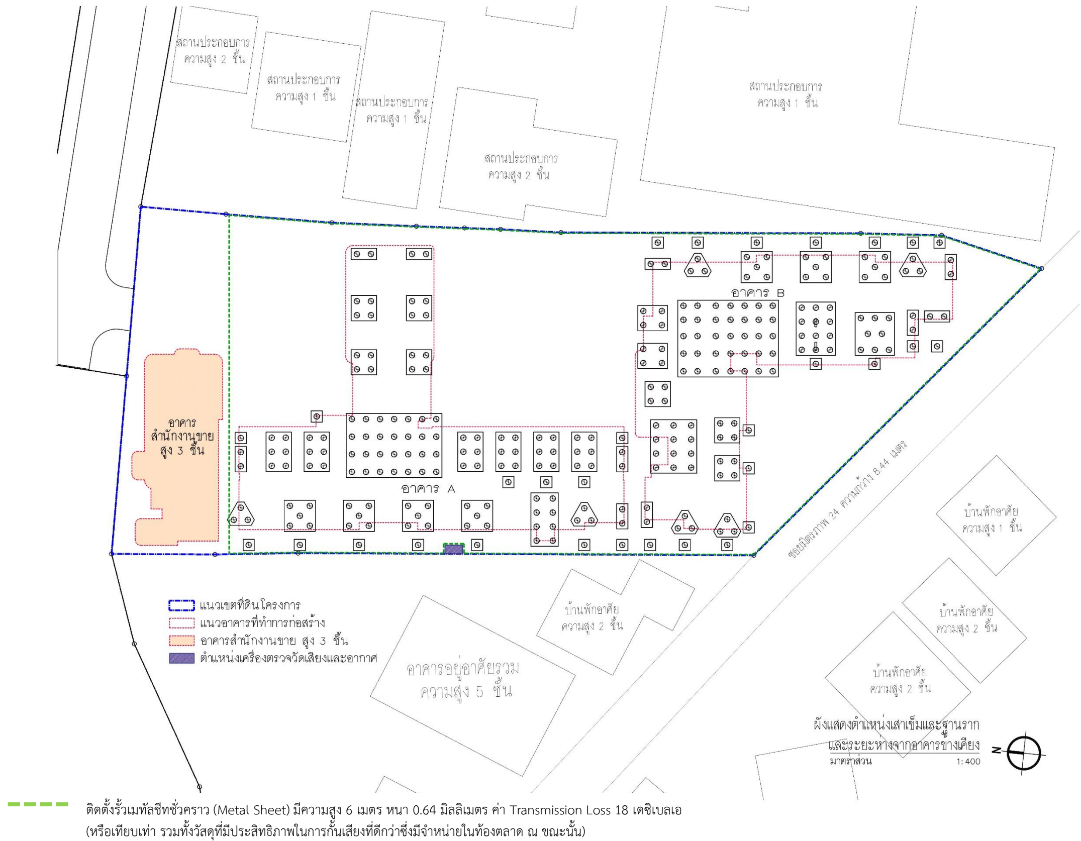
รูปที่ 4.2.5-6 ผังแสดงการติดตั้งกำแพงกันเสียงช่วงงานเสาเข็ม/ฐานราก
