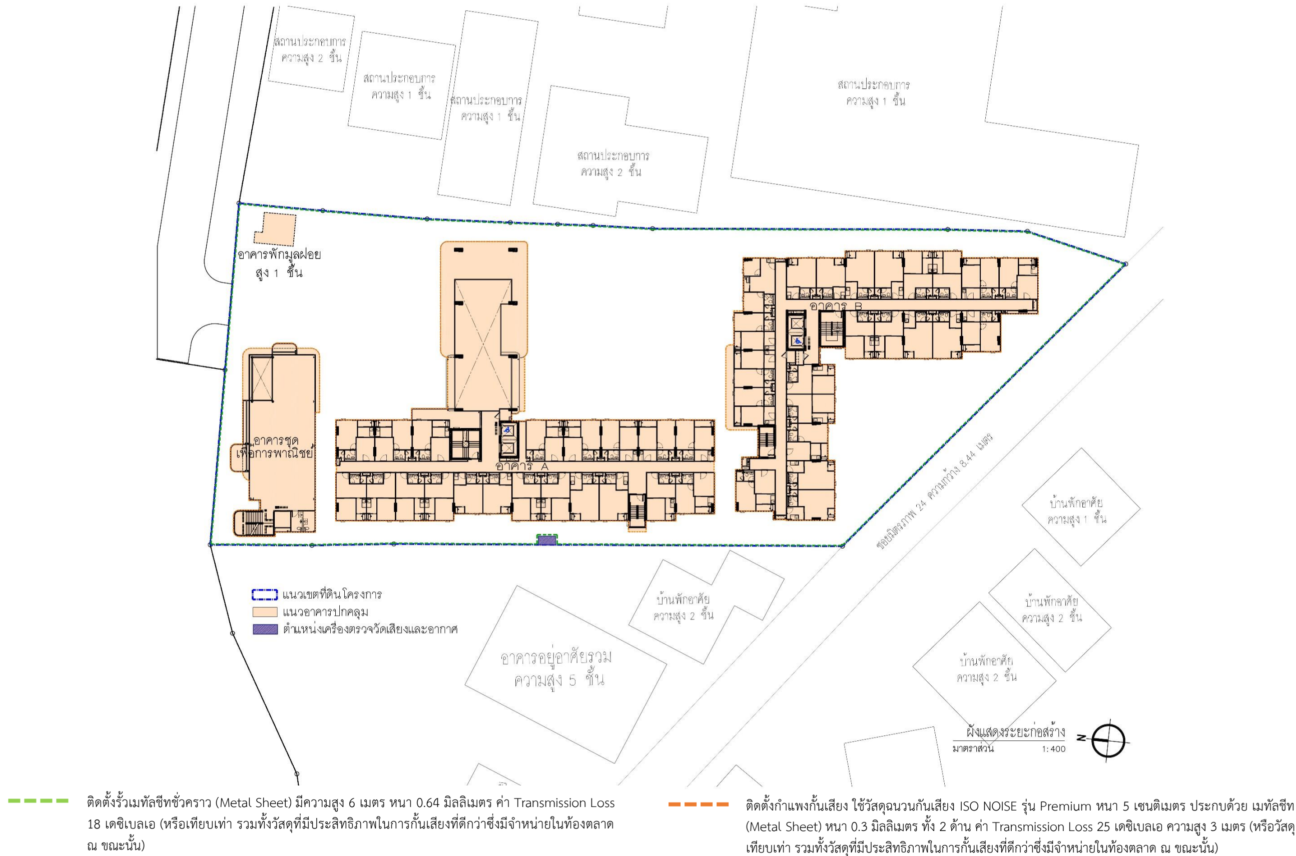
รูปที่ 4.2.5-12 แสดงการติดตั้งกำแพงกันเสียงงานโครงสร้างอาคารและงานสถาปัตยกรรม และงานระบบวิศวกรรมอาคาร งานตกแต่งภายในอาคารชุดพักอาศัย ร่วมกับงานโครงสร้างอาคารและงานสถาปัตยกรรมอาคารชุดเพื่อการพาณิชย์และอาคารพักมูลผลรวม
